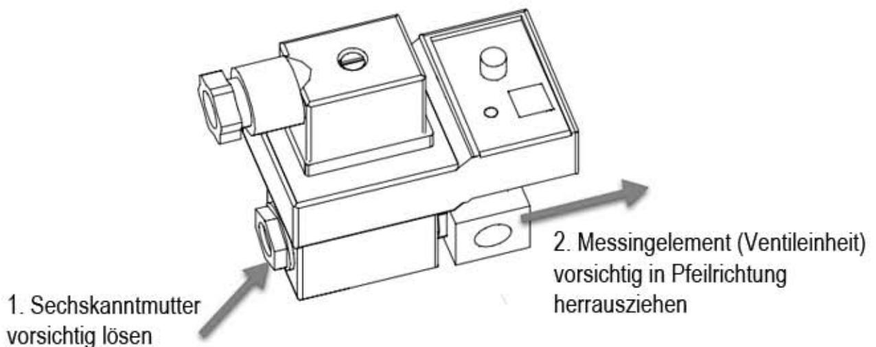
3. Zerlegen Sie das Element. Zum Reinigen der Feder empfehlen wir einfaches Waschbenzin.
